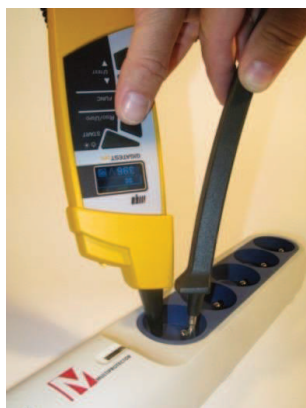
Obr. 3: Měření miliampérového bodu přepětové ochrany prodlužovačky
